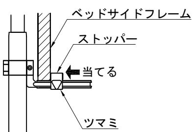
⑥ ストッパーをベッドサイドフレーム側面に押し当て、ガタツキやねじれがないようにツマミでしっかりと最後まで締め付けてください。
