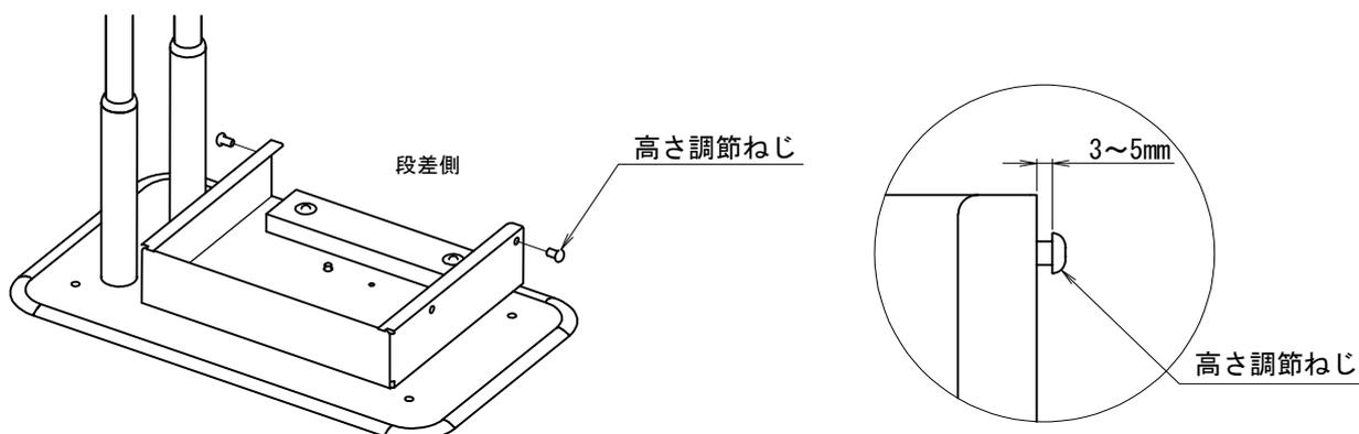
使用する高さに合わせて半がかりにした高さ調節ねじにステップ台(外)を差込み、最後に高さ調節ねじ(4ヶ所)を六角レンチ(対辺4mm)ですべて本締めしてください。
