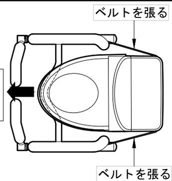
ハンドルを回して取り付けしたベルトの張りを調整するためにジョイントバーを引っ張って均等になるようにしてください。その後、ハンドルを増し締めしてベルトを張りなおしてください。
