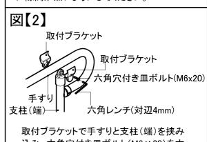
取付フラケットで手すりと支柱(端)を挟み込み、六角穴付き皿ボルト(M6×20)を六角レンチ(対辺4mm)でしっかり締め付けてください。
