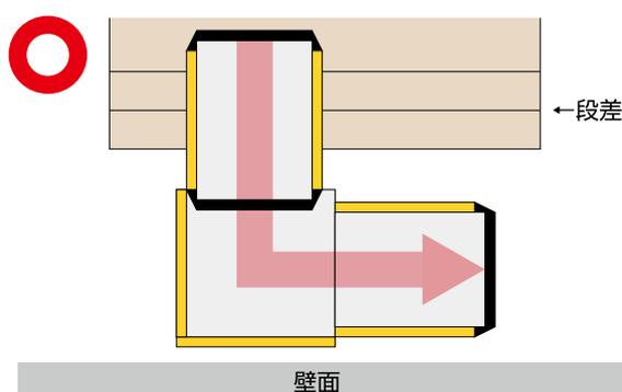
段差の向かいに壁などの障害物があることでスペースが狭く、スロープが設置できなかった場所に設置できるなど、スロープ設置方向の自由度が増します。置くだけでも使えますが、「住宅改修」としても設置できます。
