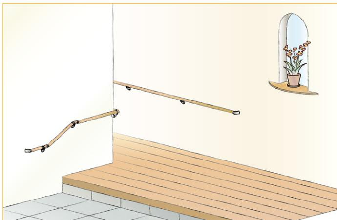
手すりを自由な長さでカットでき、ブラケットを組み合わせることで、玄関まわり・廊下・階段などさまざまな場所に取り付けることができます。
