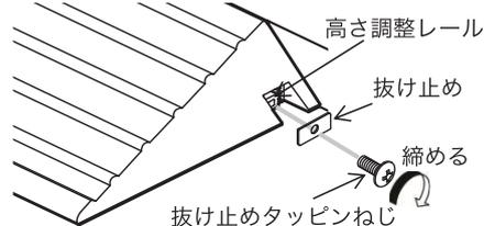
※「抜け止めタッピンねじ」を取り付ける際は、2号のプラスドライバーを使用してください。
