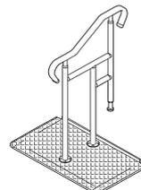
※ベースプレートコンパクトタイプの場合は、片手すりを中央に取り付けできます。
